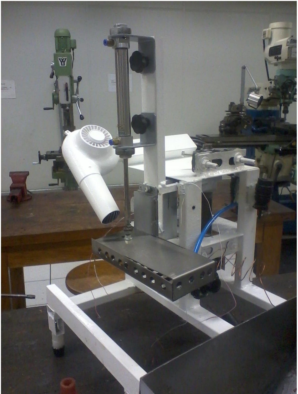
Figura 6 - Estrutura externa já com a caixa fechada onde será colocado o instrumental cirúrgico.
