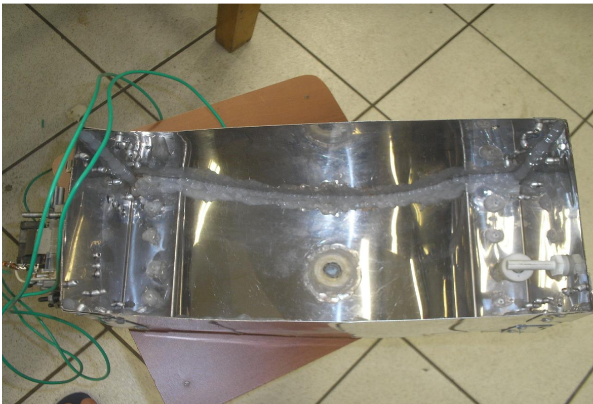
Figura 35 - Reservatório (Vista Superior), com sensor de nível e eletroválvula instalados, e vedação completa do recipiente em silicone.
