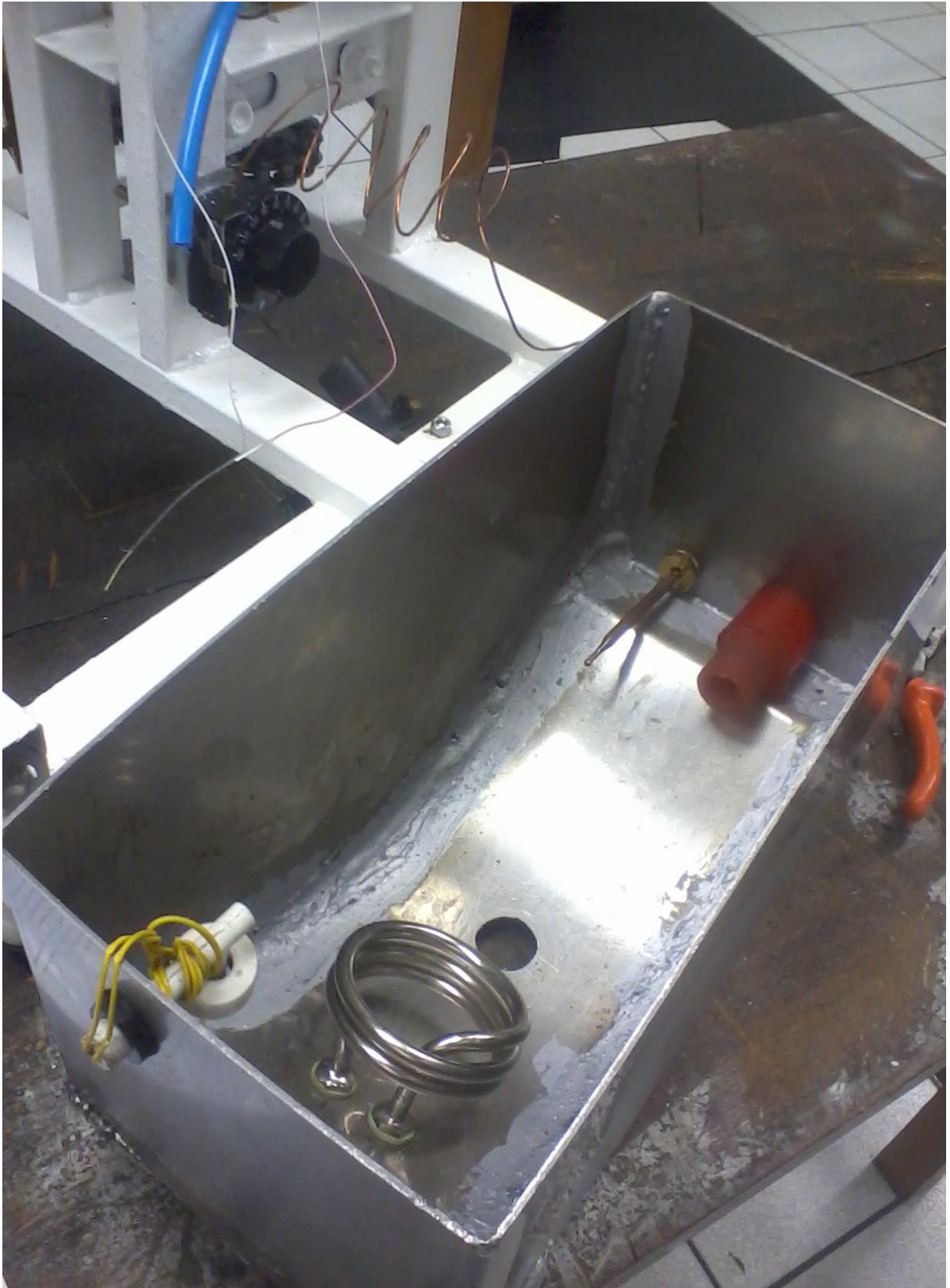
Figura 3 - Estrutura tanque de assepsia.
