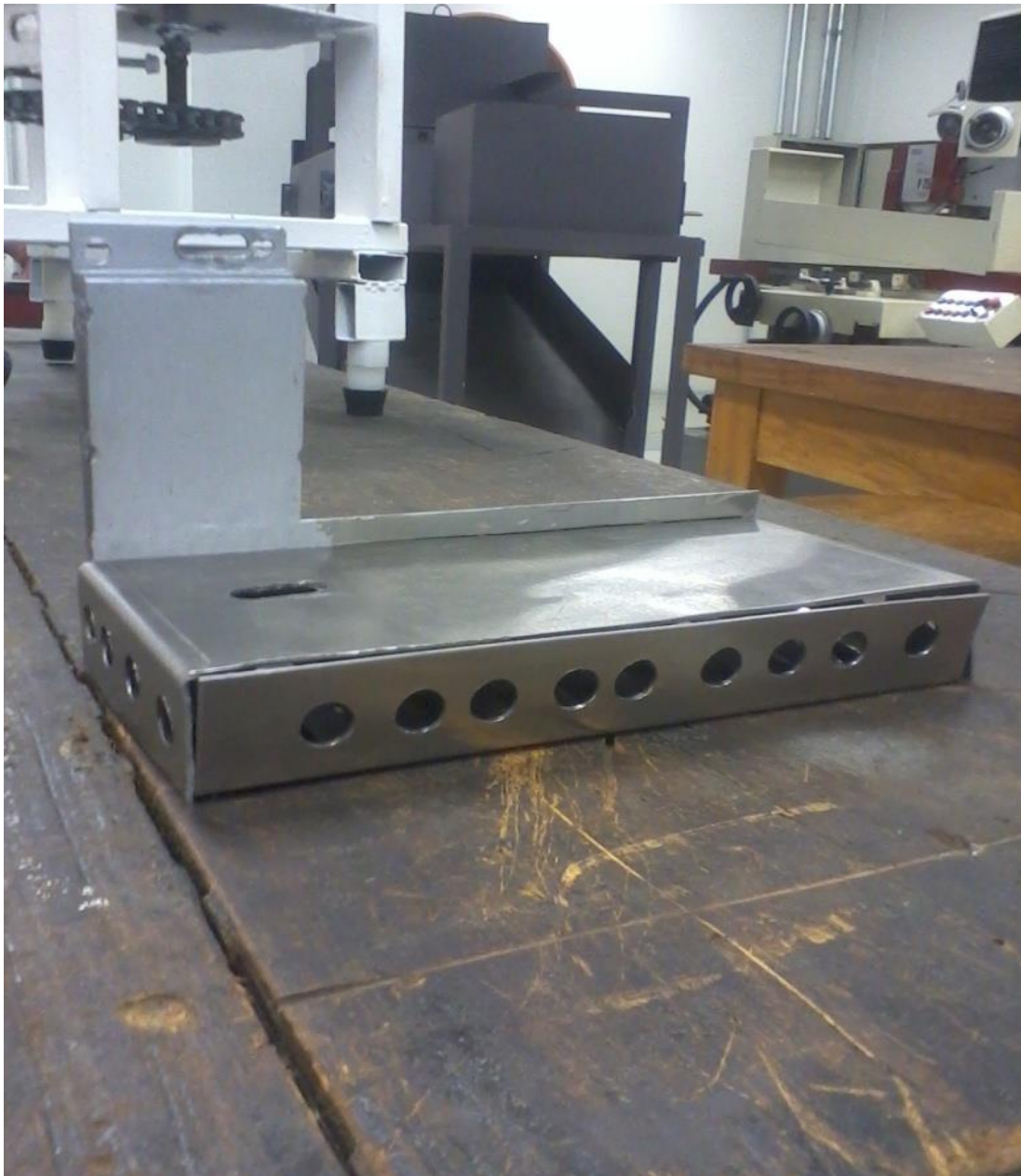
Figura 8 - Furos bilongos, na estrutura da bandeja e na estrutura onde se fixará ao projeto mecânico.
