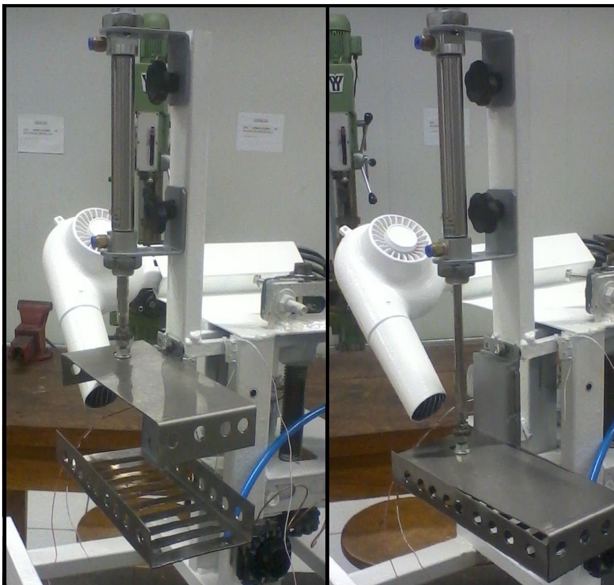
Figura 31 - Pistão pneumático instalado, 1° Aberto, 2° Fechado.
