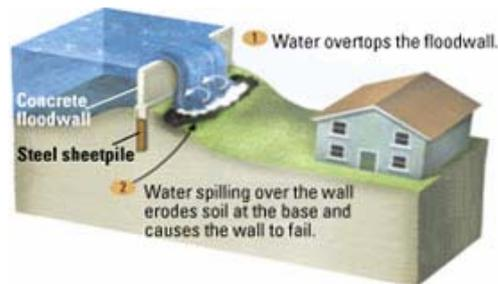
FIGURA 1: Esquema da Ocorrência de Galgamento Através de uma Parede de Concreto [11]
