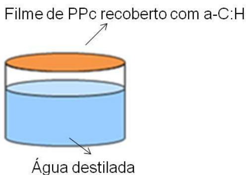
Figura 28: Ilustração esquemática do ensaio de permeação a vapor de água.
